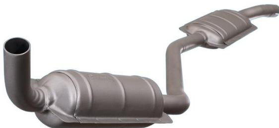
Данная технология предполагает изготовление глушителя из двух полукорпусов, которые сварены между собой вдоль всего корпуса
