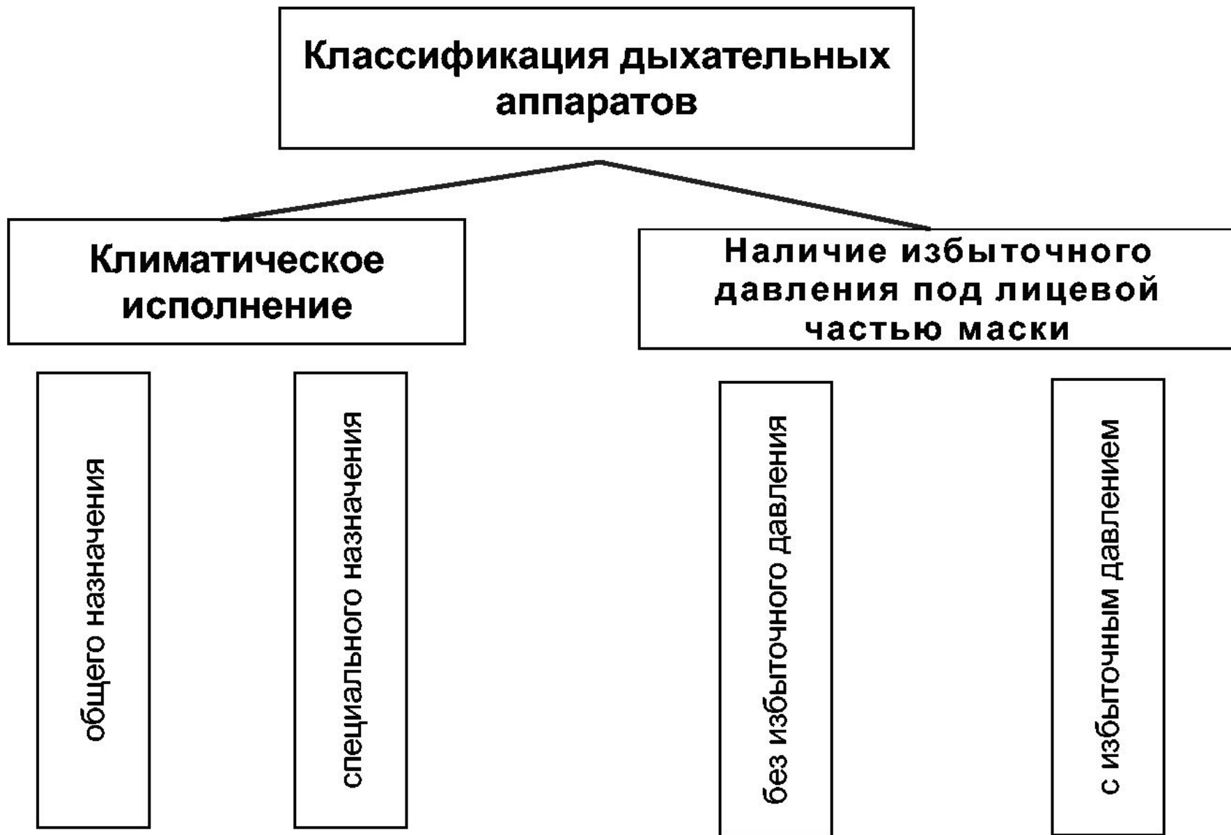
Рис. 3. Классификация дыхательных аппаратов со сжатым воздухом
