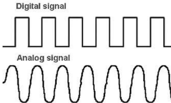
Непрерывную информацию может выдавать, например, столбик термометра, а дискретную – любой цифровой индикатор, например, электронные часы.
