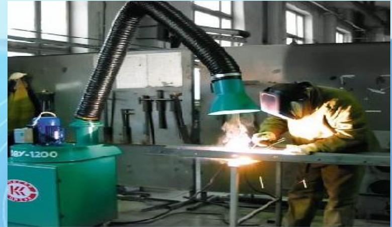
**1. Несоблюдение электробезопасности - поражение электрическим током. Это возможно при отсутствии заземления сварочного аппарата, плохой изоляции электрододержателя и проводов.**
