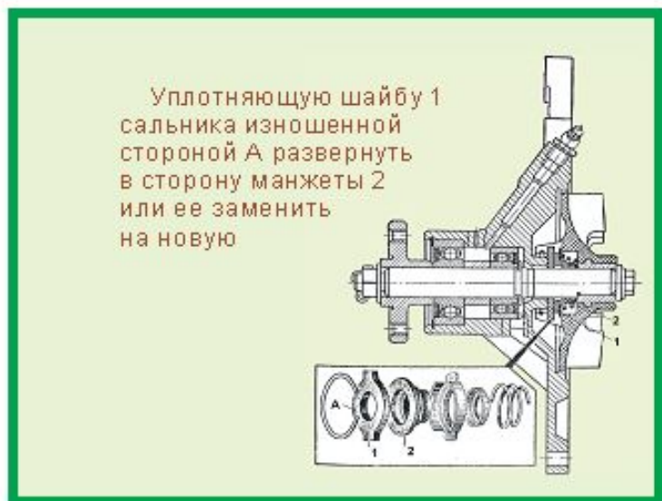
Рис. 6- Перестановка изношенной детали.¶
