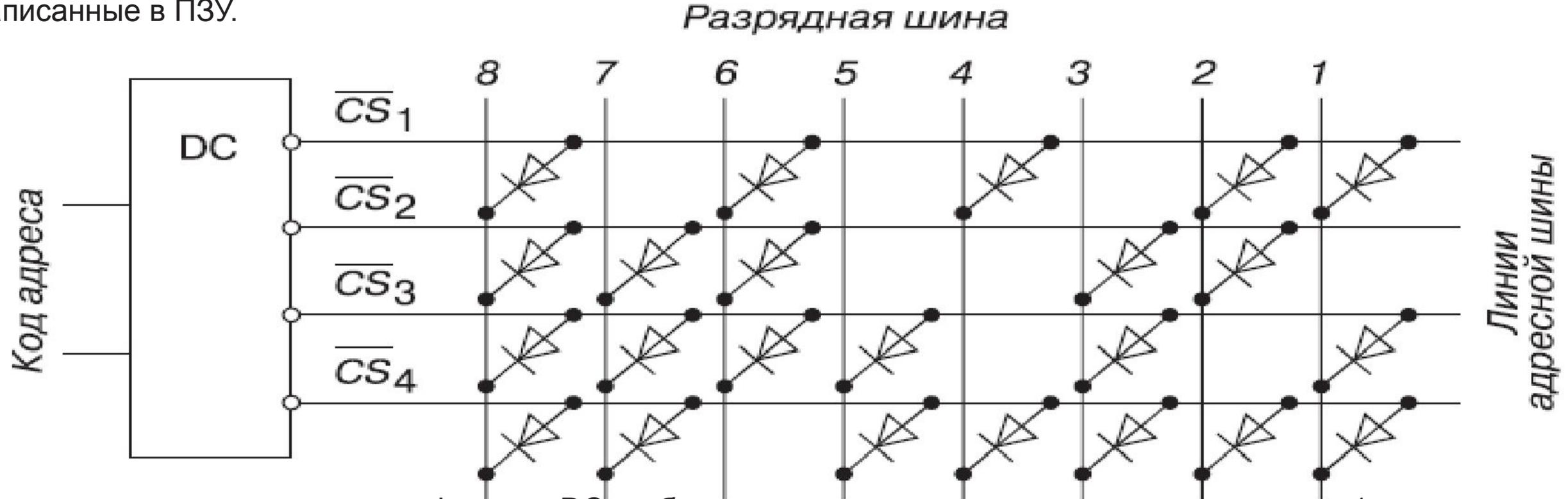
Если, например, с выхода дешифратора DC возбуждается верхняя адресная линия, то сигналы 1 проходят с неё через диоды следующих линий разрядной шины: 8, 6, 4, 2 и 1, т. е. считывается двоичное число 10101011. Аналогично, при возбуждении других линий адресной шины на выходе ПЗУ будут считываться три других двоичных числа. Заметим, что в данном примере диодная матрица является совокупностью элементов ИЛИ: входами элементов являются линии адресной шины, а выходом — одна из линий разрядной шины.
