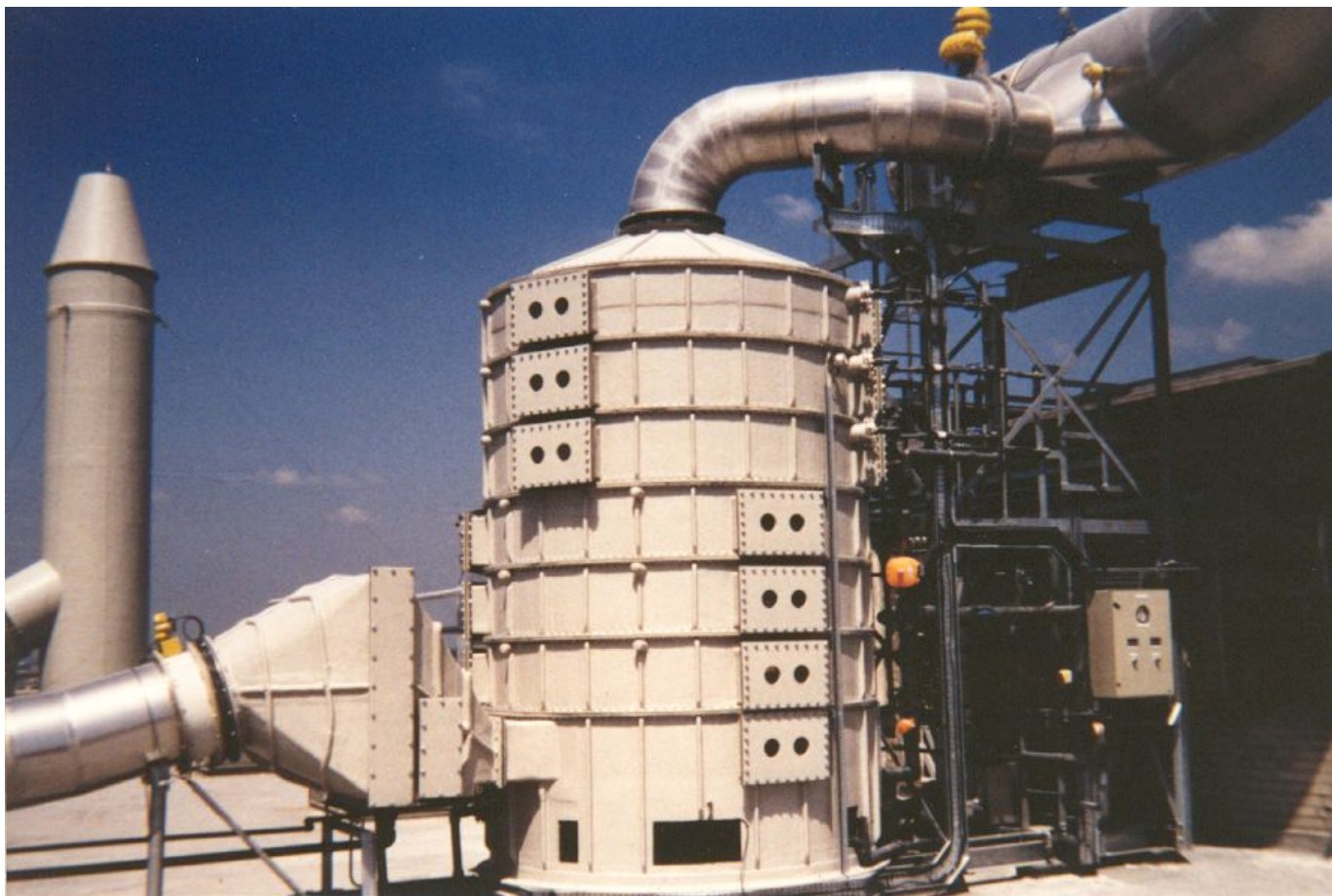
Внешний вид биофильтра с загрузкой из синтетического волокна (разработка Института биохимии РАН).
