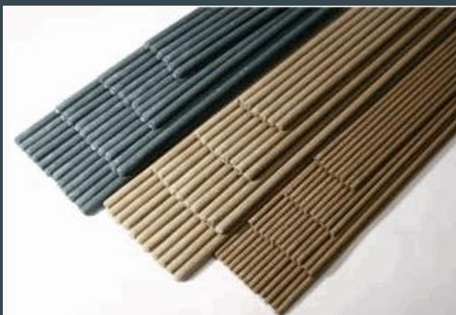
для сварки углеродистых и низколегированных конструкционных сталей с временными сопротивлением разрыву до 600 МПа (60 кгс/мм<sup>2</sup>);
