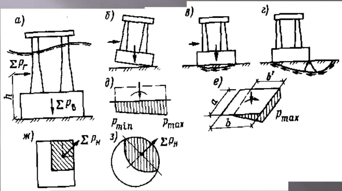
а) нагрузки на основание платформы; б) устойчивость сооружения от опрокидывания; в) устойчивость от сдвига по подошве; г) устойчивость от сдвига и опрокидывания при глубинном сдвиге в грунтовом массиве; д) распределение давлений по подошве основания; е) распределение давлений при отрыве подошвы; ж) эффективная площадь опирания прямоугольной фундаментной плиты; з) эффективная площадь опирания круглой в плане фундаментной плиты.
