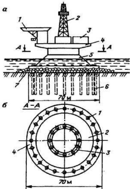
*а* – вид сбоку: 1 – вертолетная площадка, 2 – буровая вышка, 3 – блок-модули верхнего строения, 4 – палуба, 5 – опорный блок, 6 – сваи, 7 – каменно-щебеночный материал; *б* – план разреза платформы по линии А – А: 1 – стальные сваи, 2 – опорный блок, 3 – внутреннее кольцо со сваями, 4 – свайный ростверк
