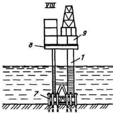
Последовательность работ по строительству стальной ЛСП со свайным фундаментом
