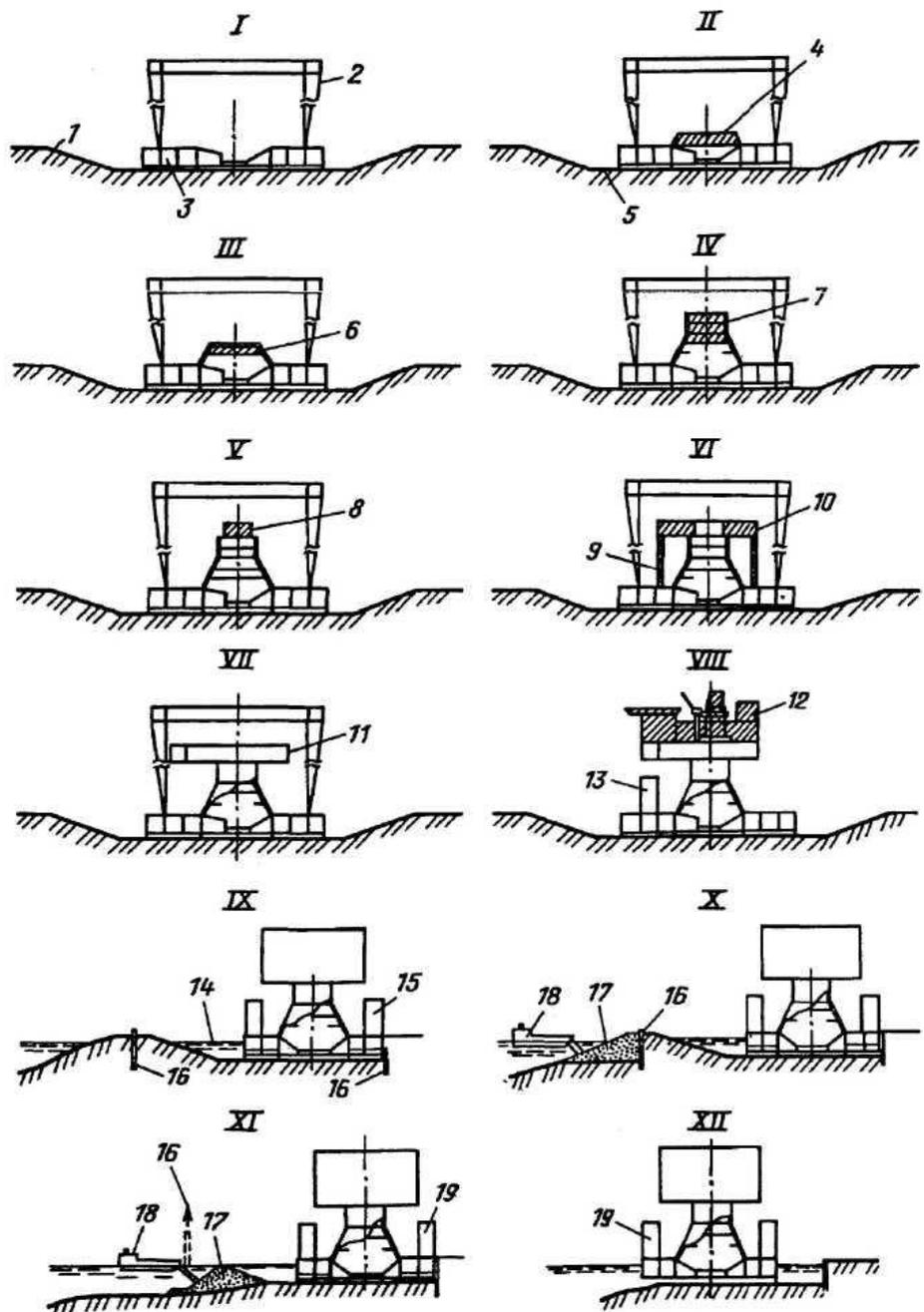
Последовательность работ по строительству сталежелезобетонной платформы с гравитационным фундаментом
