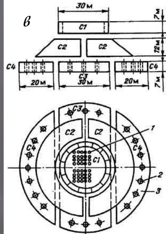
1 – кондукторы; 2 – сваи; 3 – свайный ростверк; C1 – C4 – монтажные блоки платформы
