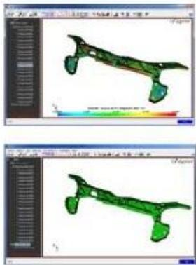
Импорт сеточных моделей из системы моделирования технологических процессов и системы КЭ моделирования
