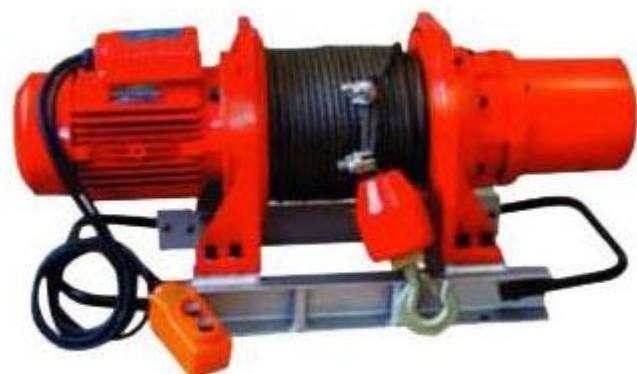
Грузоподъёмная машина в виде вращающегося барабана с тяговым стальным канатом и с приводом от электродвигателя. Подъемные лебедки используют главным образом для вертикального подъёма груза, тяговые лебёдки – для горизонтального перемещения груза. Подъёмные подвесные лебёдки называют талями, а при наличии у них механизма передвижения по подвесным путям – передвижными талями.
