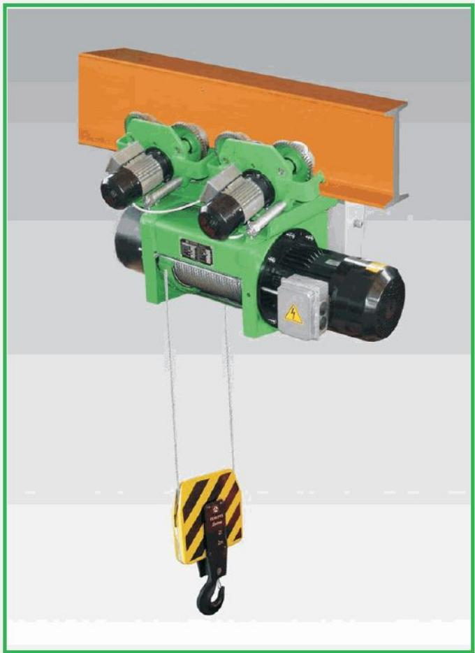
Грузоподъемная машина с электроприводом и механизмом подъема и горизонтального перемещения. Электроталь состоит из трех основных узлов: грузоподъемного механизма, служащего для подъема и опускания грузов; ходовой тележки; кнопочной станции для управления электроталю. Электроталь снабжается электроэнергией от сети. Они могут работать на открытом воздухе, но обязательно под общим или местным навесом, что предохраняет от попадания в механизм снега и дождя.
