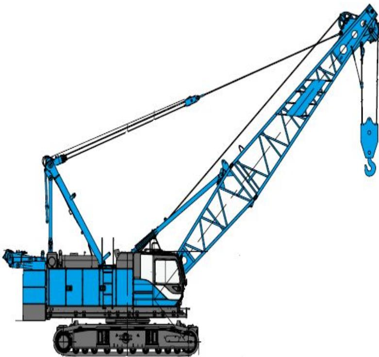
Машина циклического действия, предназначенная для подъема и перемещения в пространстве грузов, удерживаемого грузозахватными приспособлениями. В зависимости от конструкции различают грузоподъемные краны: мостовые, козловые, краны-штабелеры, автомобильные, башенные строительные и другие.
