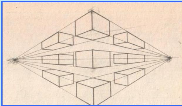
Все параллельные линии будут сходитьсь в две точки схода, расположенные на линии горизонта справа и слева.
