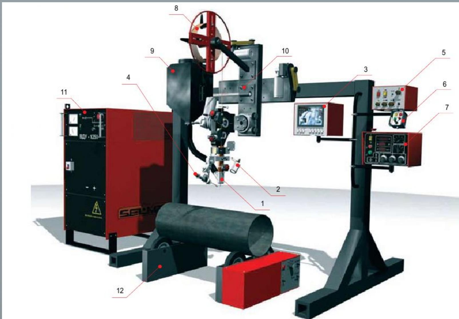
Сварочная установка на базе головки АДФ-1000
