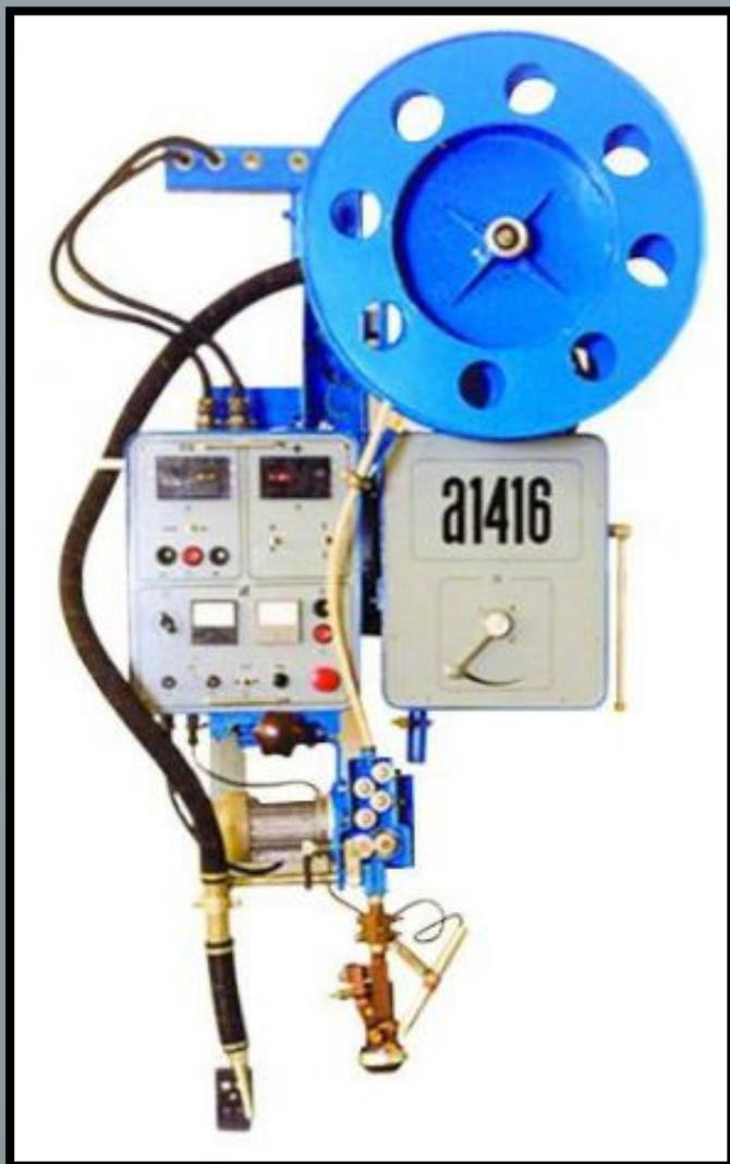
Подвесной самоходный автомат предназначен для дуговой сварки низкоуглеродистых и легированных сталей плавящимся электродом (сплошная проволока) под флюсом на постоянном токе с независимыми от параметров дуги скоростями сварки и подачи электродной проволоки.
