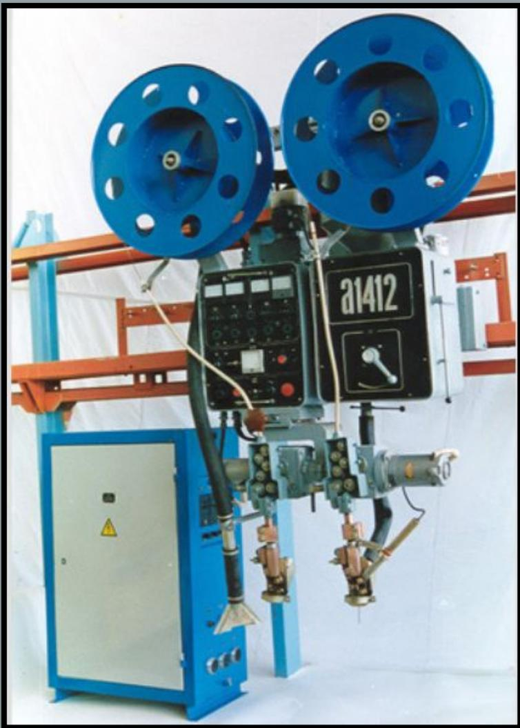
Автомат подвесной самоходный предназначен для двухдуговой сварки низкоуглеродистых и легированных сталей плавящимся электродом под слоем флюса на постоянном токе с независимым от параметров дуги скоростями сварки и подачи электродной проволоки.
