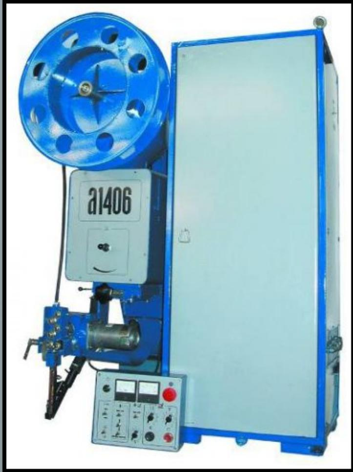
Автомат предназначен для электродуговой сварки или наплавки низкоуглеродистых и легированных сталей плавящимися электродами (сплошной и порошковой проволокой).
