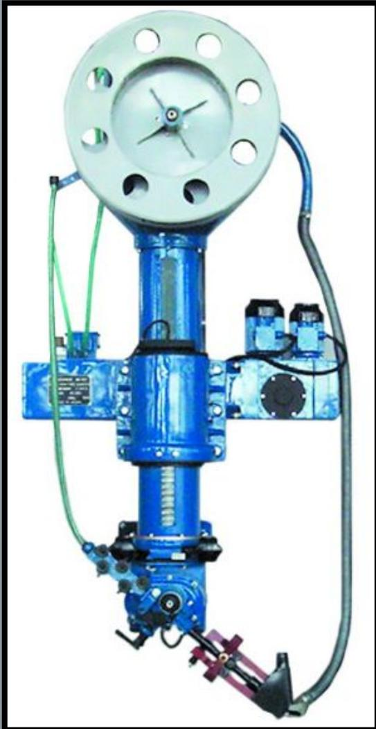
Подвесной самоходный автомат предназначен для широкого круга наплавочных и сварочных работ в продолжительном режиме различными электродами.
