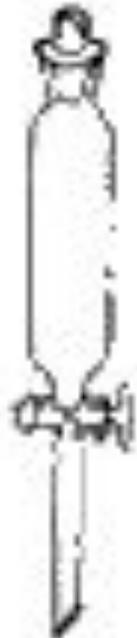
**Воронка делительная** предназначена для разделения несмешивающихся жидкостей, имеющих разную плотность.
