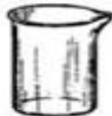
Химический стакан с носиком служит для хранения жидких и твердых веществ, а также для проведения простейших химических операций (растворение, нагревание).
