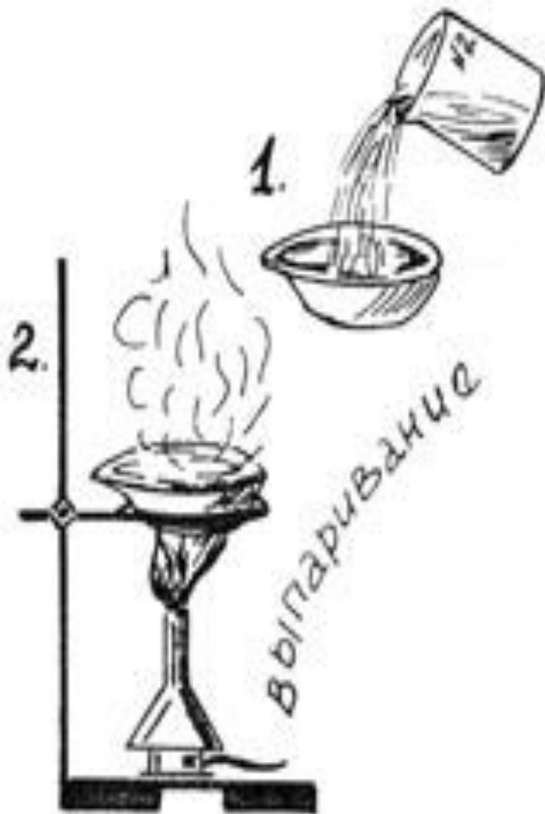
При выпаривании используют фарфоровые чашки. Выпаривание применяют в том случае, когда нужно выделить растворенное вещество из раствора. В фарфоровую чашку наливают раствор — не более  $\frac{1}{3}$  ее объема. Устанавливают чашу на кольцо штатива и греют на открытом пламени при постоянном помешивании
