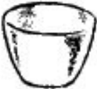
**Тигель фарфоровый** предназначен для нагревания и прокаливания твердых веществ при высокой температуре.
