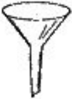
**Воронка конусообразная** служит для переливания жидкостей и фильтрования.
