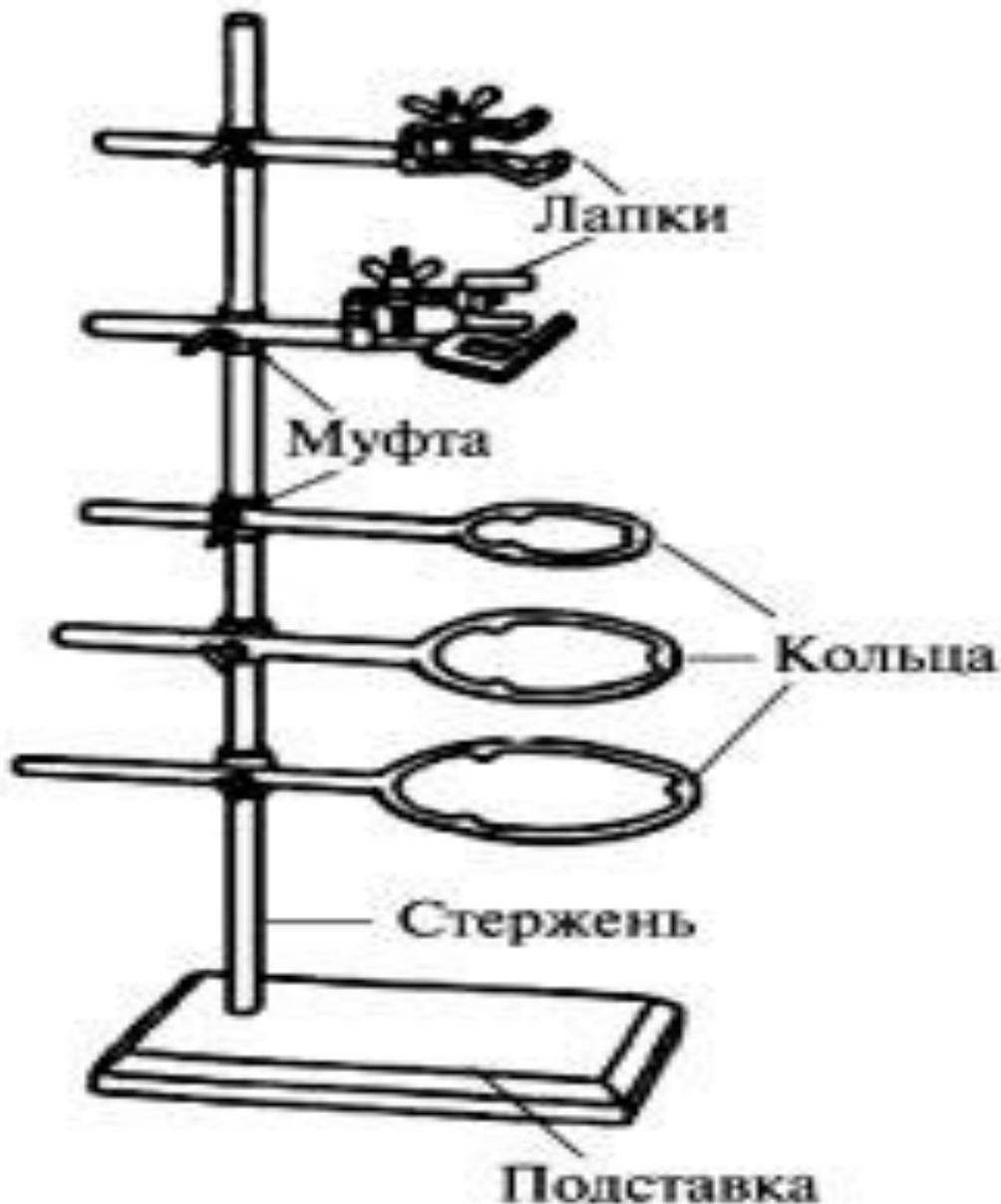
Штатив служит для крепления деталей химических установок при выполнении опытов. Он состоит из массивной чугунной подставки, в которую ввинчен стержень. На стержне при помощи муфт укрепляют лапки и кольца
