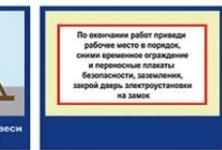
По окончании работ приведи рабочее место в порядок, снимки временное ограждение и переносные плакаты безопасности, заземления, закрой дверь электроустановки на замок.
