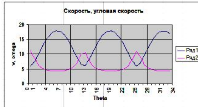
Рис. 26: Скорость и угловая скорость робота на эпитрохоиде.
