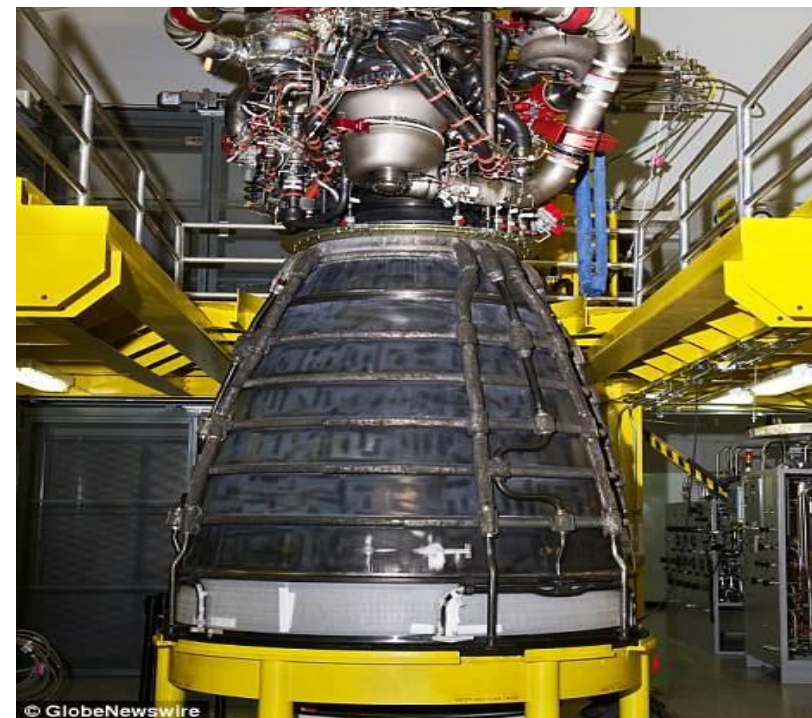
Кислородно-водородный ЖРД Aerojet Rocketdyne AR-22, созданный на базе двигателей RS-25 МТКК Space Shuttle
