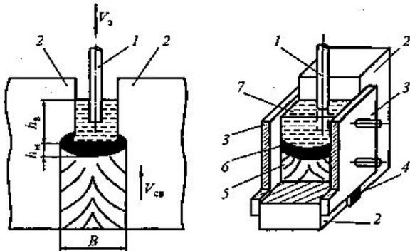
Рис. 104. Схема электрошлаковой сварки:
