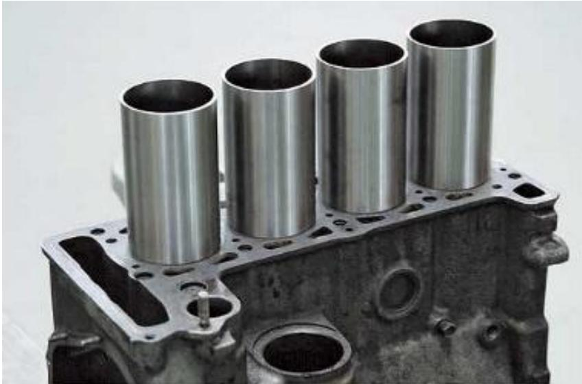
Могут быть **«мокрыми»** или **«сухими»** - в зависимости от того, контактируют ли они непосредственно с охлаждающей жидкостью в рубашке охлаждения двигателя.
