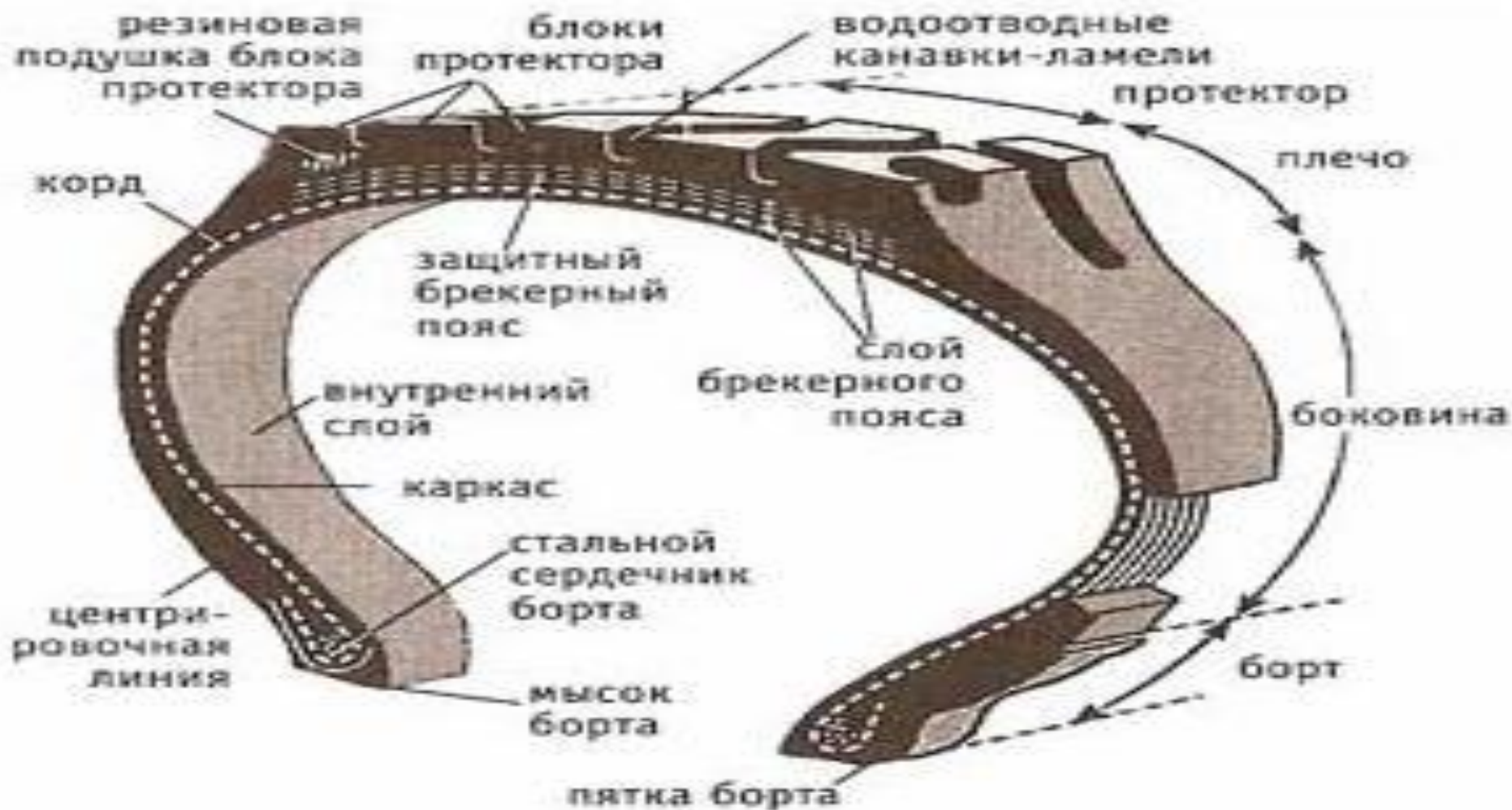
Рис.4. Устройство пневматической шины
