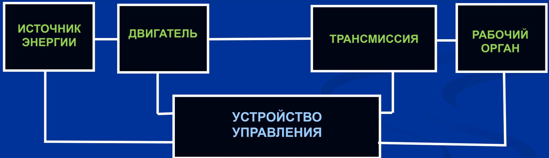
***Следствие: чтобы техническая система была управляемой, необходимо, чтобы управляемой была хотя бы одна её часть.***
