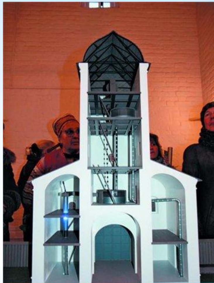
Водовзводная башня в Коломенском (в разрезе)
