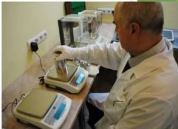
Рис 1 Поверка и калибровка средств измерений (СИ) механических величин:
