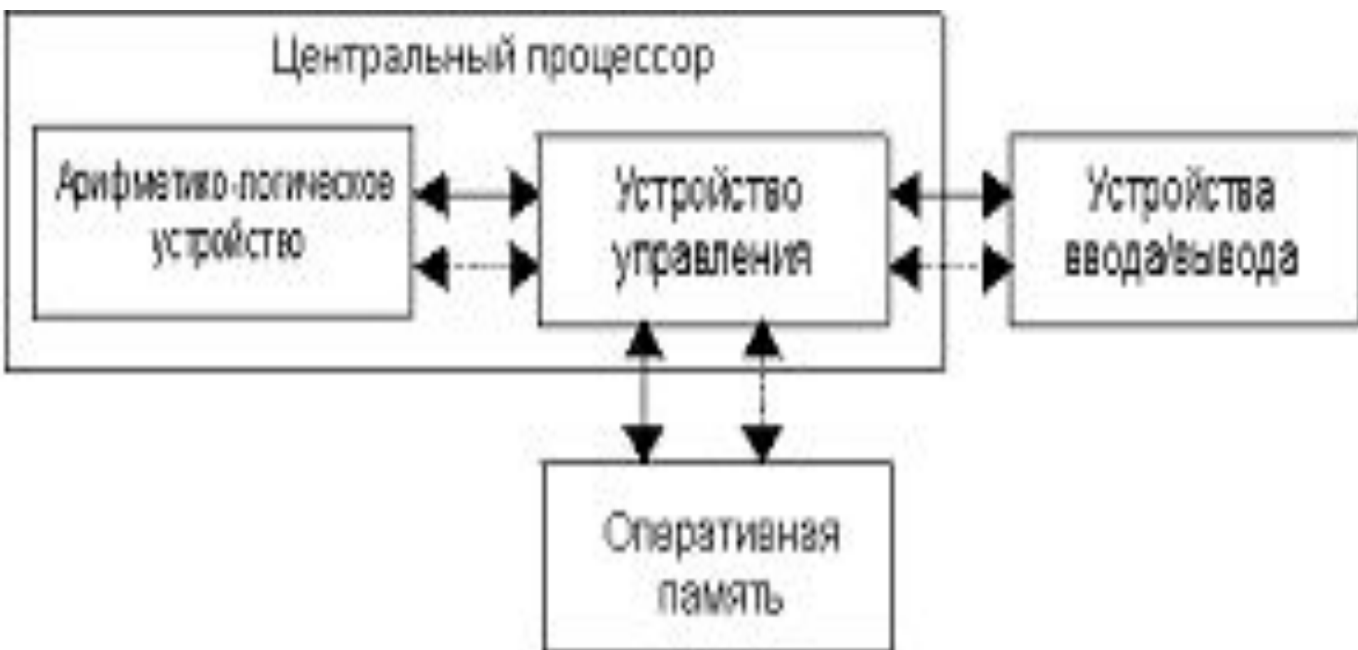
Рисунок 6 - Логическая организация универсального вычислительного устройства
