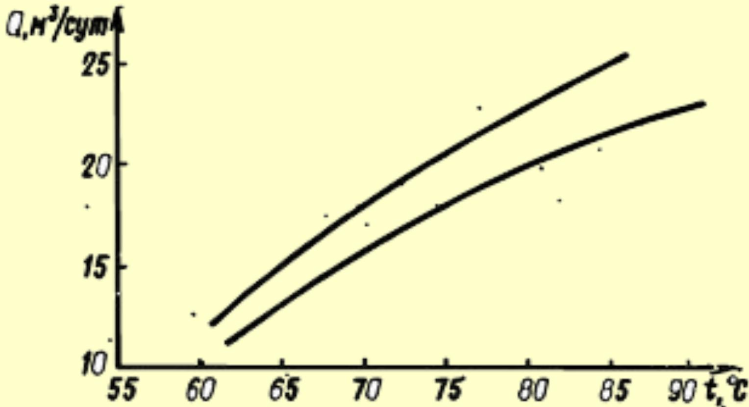
Рис. 2. Зависимость производительности ( $Q$ ) установки опреснения от расхода и температуры ( $t$ ) воды (после головного подогревателя)
