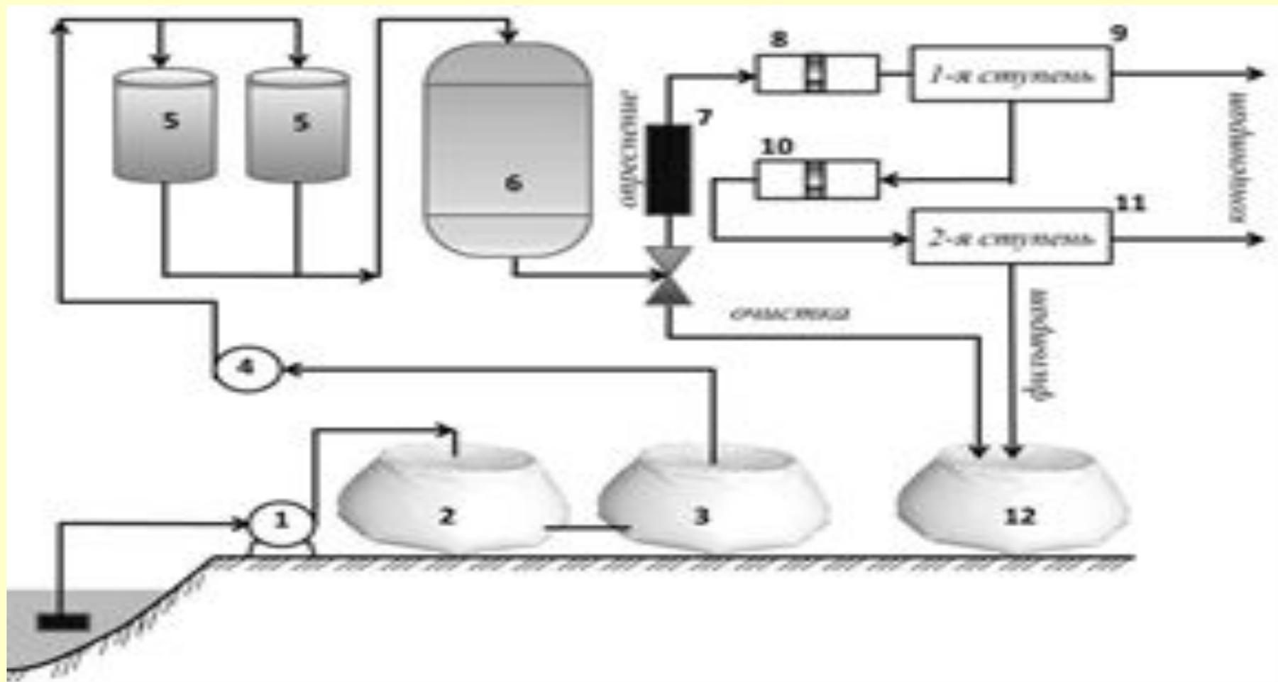
1 - насос первого подъема; 2,3,12 – резервуары для воды; 4-насос второго подъема;
