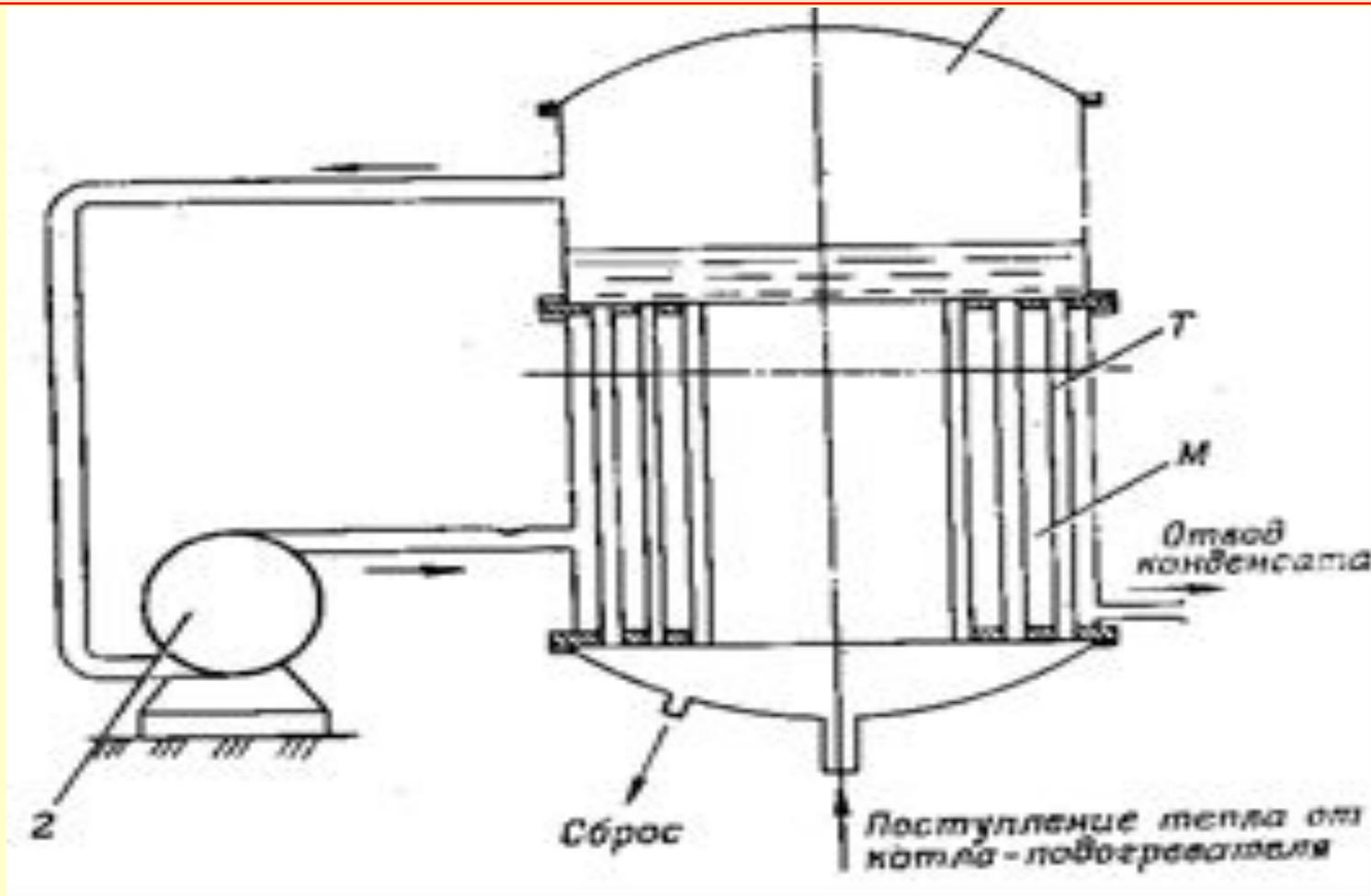
1 – выпарной аппарат; 2 – термокомпрессор; Т – полость испарения;
