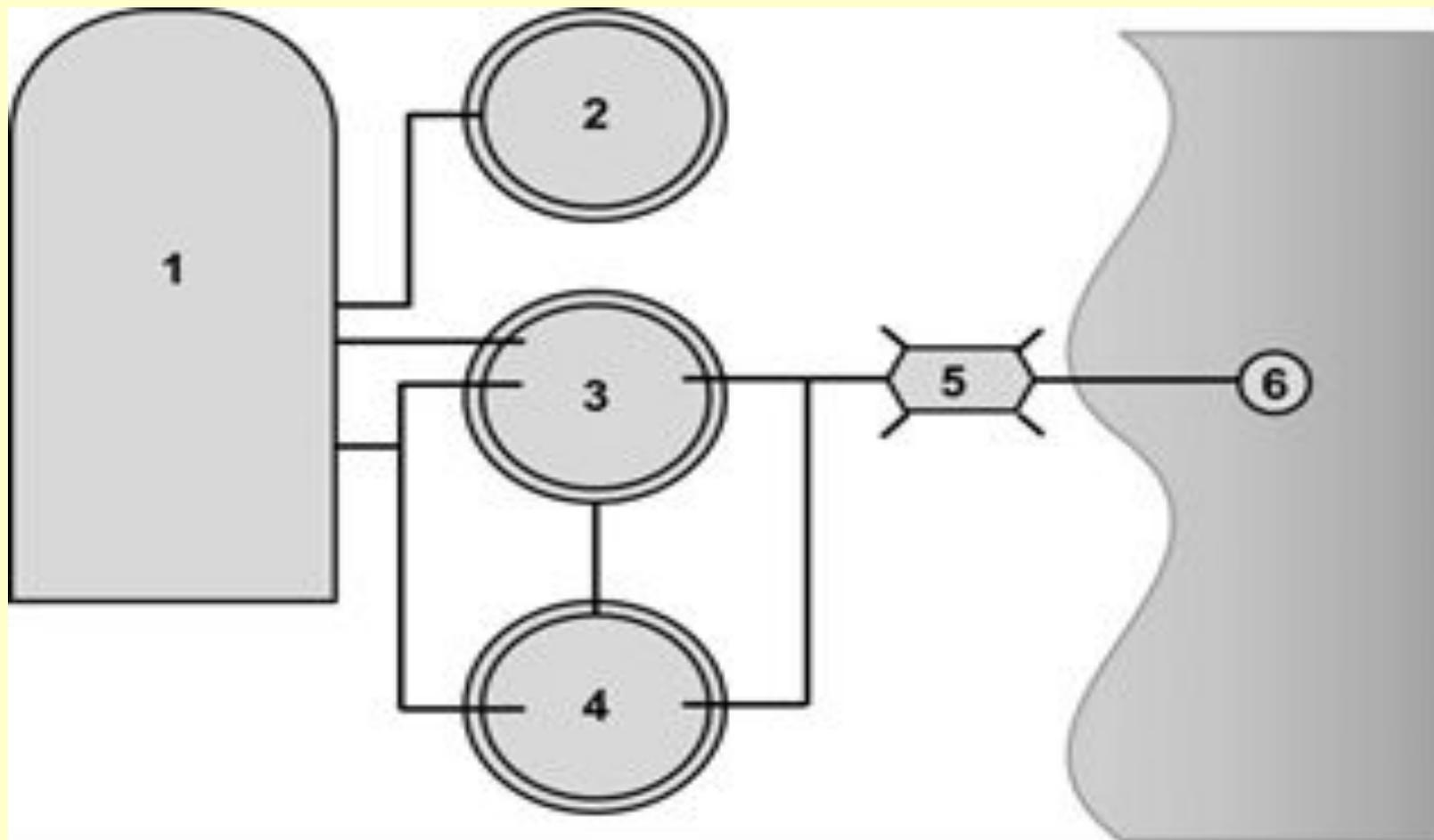
1 - ОПС-5; 2 - РДВ-5000 для чистой воды; 3 и 4 - РДВ-5000 для исходной воды; 5 - насос первого подъёма; 6 - водозабор
