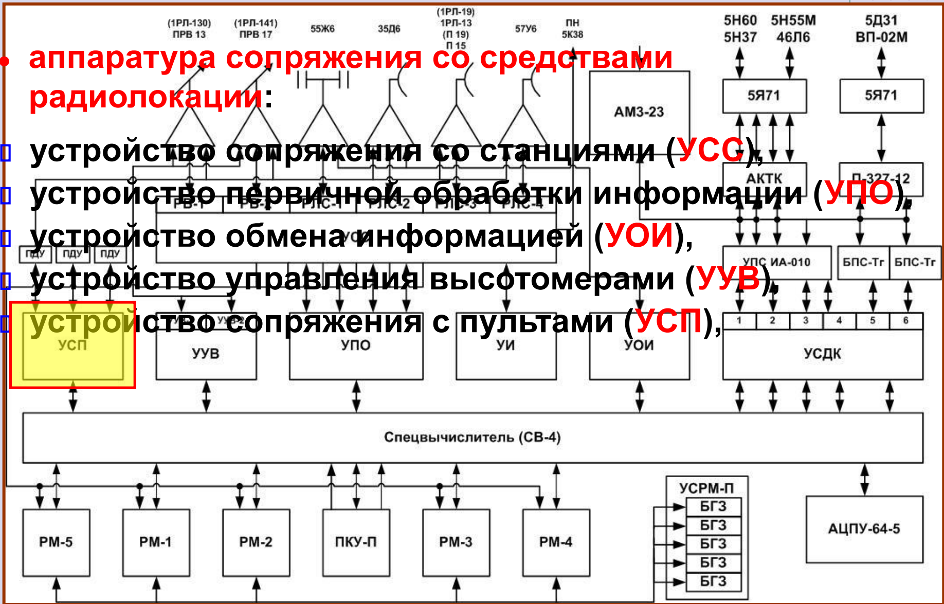
Рис.3.1 Состав и размещение аппаратуры автоматизации в аппаратном прицепе П1
