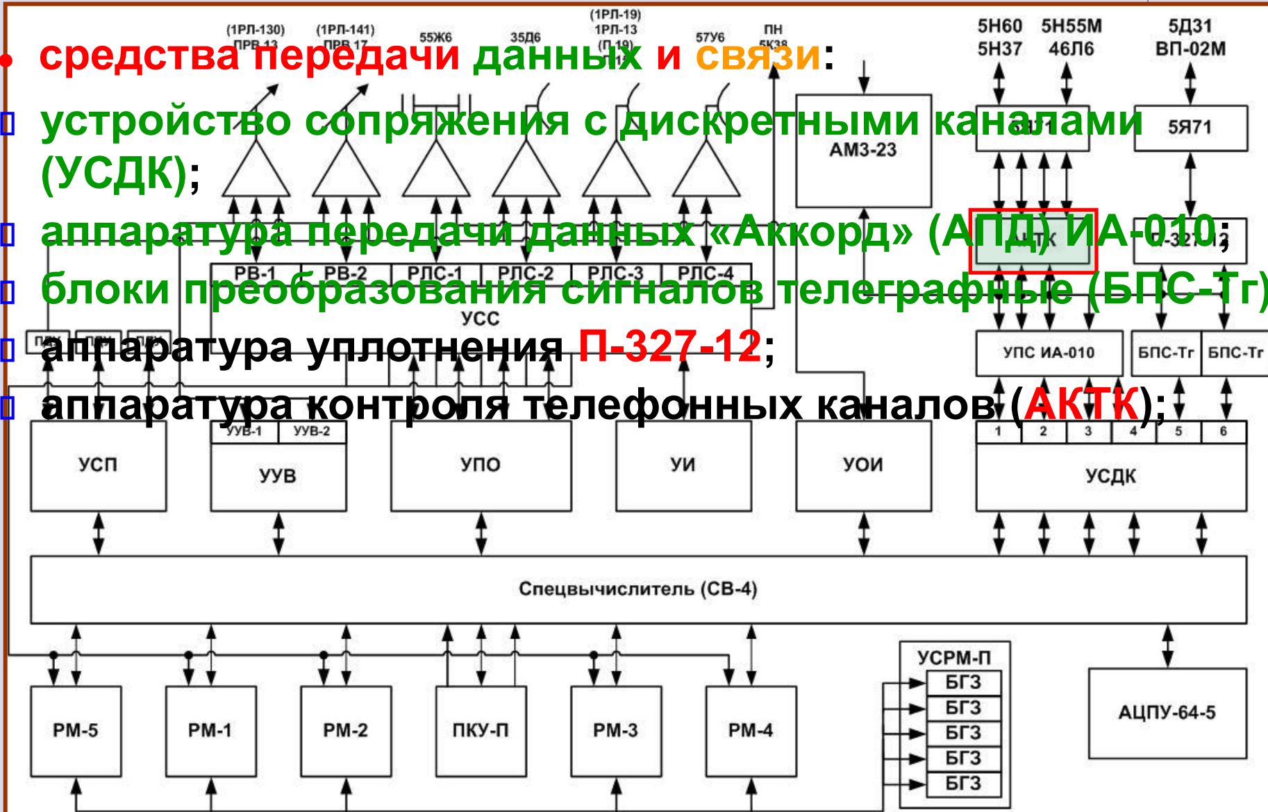
Состав и размещение аппаратуры автоматизации в аппаратном прицепе П1
