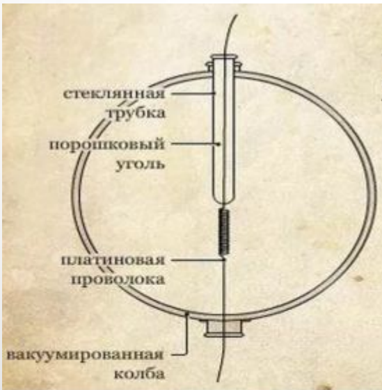
Схема лампы Фредерика де Моллейна
