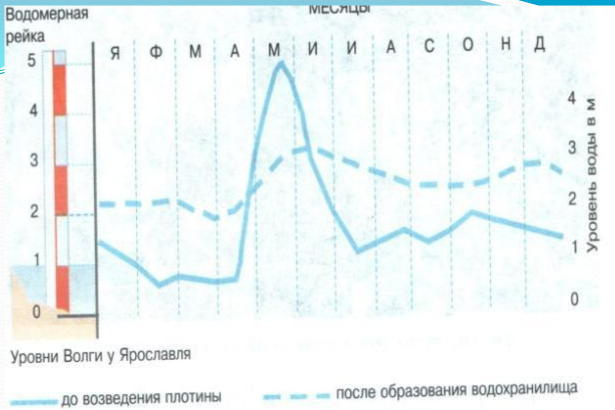
Рис. 59. График изменения уровня Волги у города Ярославля до и после возведения плотин
