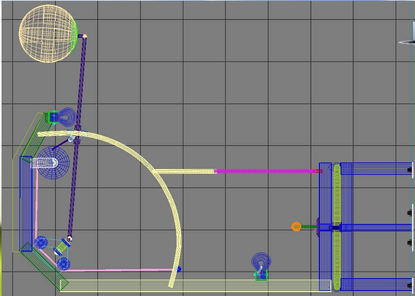
Мяч устанавливается на нужной высоте с помощью центрального зажима.
