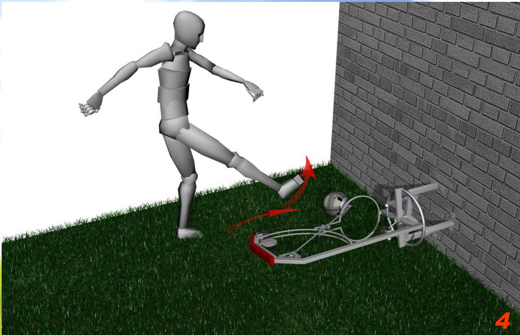
Мяч легко преодолевает натяжение растяжки, смещается по дуге и сталкивается с амортизатором.
