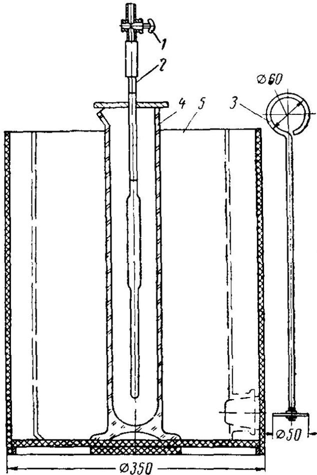
Рис. 1.1. Сидиментометр.
