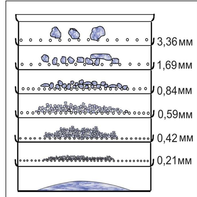
Ситовой анализ сыпучих горных пород применяют для определения содержания фракций частиц размером от 0,05 до 6 - 7 мм, а иногда и до 100 мм. В лабораторных условиях обычно пользуются набором проволочных или шелковых сит с размерами отверстий (размер стороны квадратного отверстия) 0,053; 0,074; 0,105; 0,149; 0,210; 0,227; 0,42; 0,59; 0,84; 1,69 и 3,36 мм.
