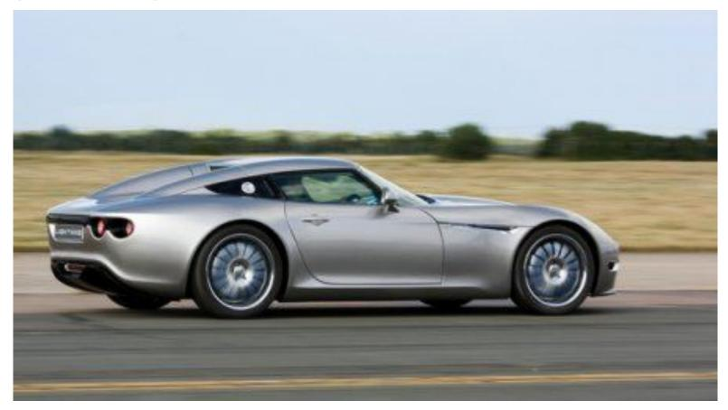
Весом в 300 кг (вместе с водителем), Xof1 оснащен 96 вольтовым электродвигателем и работает от литиево-ионного аккумулятора 3.8 кВт. Он способен разогнаться от 0-60 миль в час за 6 секунд, максимальная скорость – 75 миль в час, полного заряда
