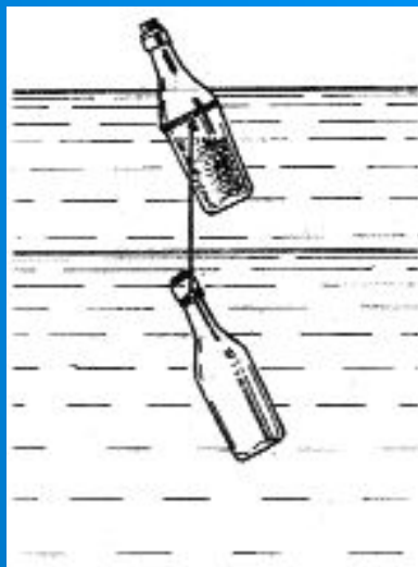
Рис. Поплавок для определения скорости течения реки
