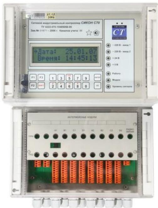
Контроллеры СИКОН С70 предназначены для измерений и многотарифного учёта электрической энергии, мощности, а также сбора, обработки, хранения, отображения и передачи информации на верхний уровень автоматизированных информационно-измерительных систем (АИИС).
