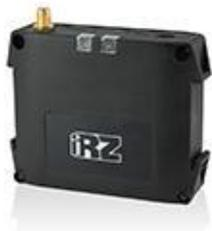
Беспроводной GSM/GPRS-модем iRZ ATM2 обеспечивает передачу данных в сети GPRS по стеку протоколов TCP/IP. Модем автоматически подключается к сети GPRS и устанавливает соединение с заданным сервером. Обеспечивается прозрачное взаимодействие между сторонним программным обеспечением и внешним устройством, подключенным к модему по интерфейсу RS232. Модем отслеживает состояние GPRS-соединения и в случае его потери самостоятельно восстанавливает соединение.
