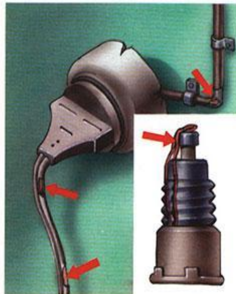
Неисправность электропроводки Пользование самодельными предохранителями
