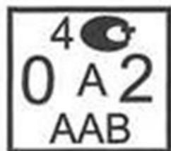
Рисунок 4.4 – Поверительное клеймо юридического лица или индивидуального предпринимателя, аккредитованного на право поверки средств измерений, применяемое при клеймении средств измерений, находящихся в эксплуатации или после ремонта
