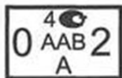
Рисунок 4.3 – Поверительное клеймо юридического лица или индивидуального предпринимателя, аккредитованного на право поверки средств измерений, применяемое при клеймении средств измерений, выпускаемых из производства
