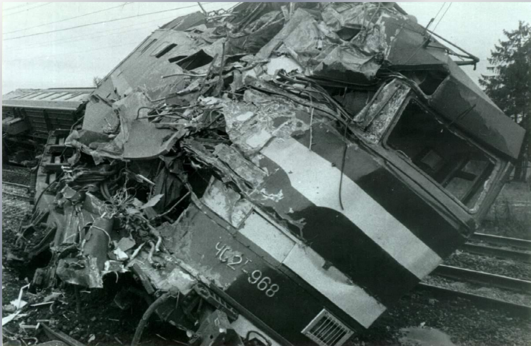
Деформация электровоза при ударе о цистерну грузового поезда
