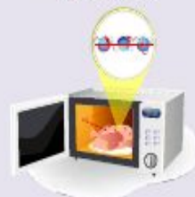
Рис. 4. Переменное поле в микроволновой печи раскачивает молекулы
