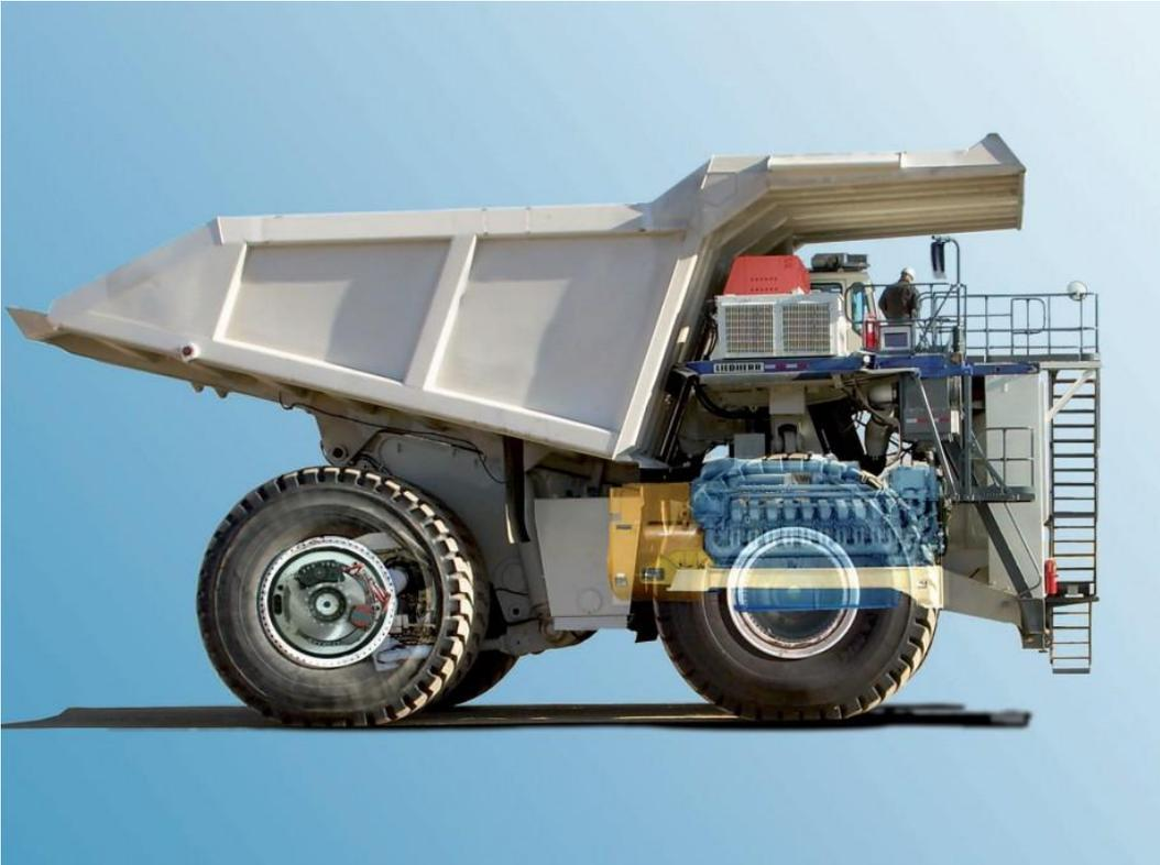
Немецкий самосвал Liebherr T 282B – самый большой на сегодняшний день автомобиль в мире. Он весит 222 тонны, а чтобы попасть в кабину такого монстра придется подняться по лестнице из 16 ступеней. В его кузове можно свободно перевозить большой загородный дом. Полезная нагрузка грузовика составляет 363 тонны – Liebherr T282B.
