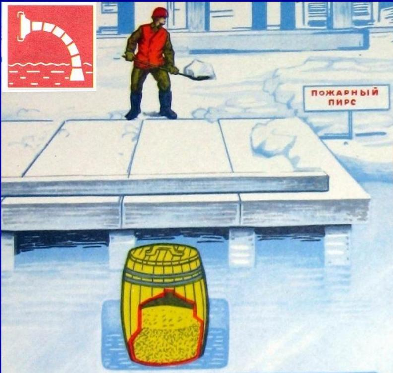
Пожарные резервуары (подземные и полуподземные) должны оборудоваться люком с двумя крышками, промежуток между которыми на зимний период должен заполняться теплоизоляционным материалом (опилками, мелкими стружками, уплотненной соломой и др.).
