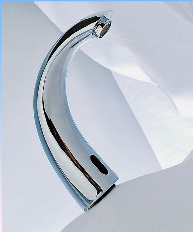
*Австрийская фирма Korfgescheit производит сантехническое оборудование и замки с электронным управлением. Бесконтактные смесители для раковины (8 моделей различной формы, зона срабатывания датчика - 25 см) и душа (2 модели, зона срабатывания датчика - 60 см) подают предварительно подготовленную теплую воду. Выполнены они из хромированной бронзы, питаются от батареек типа АА.*
