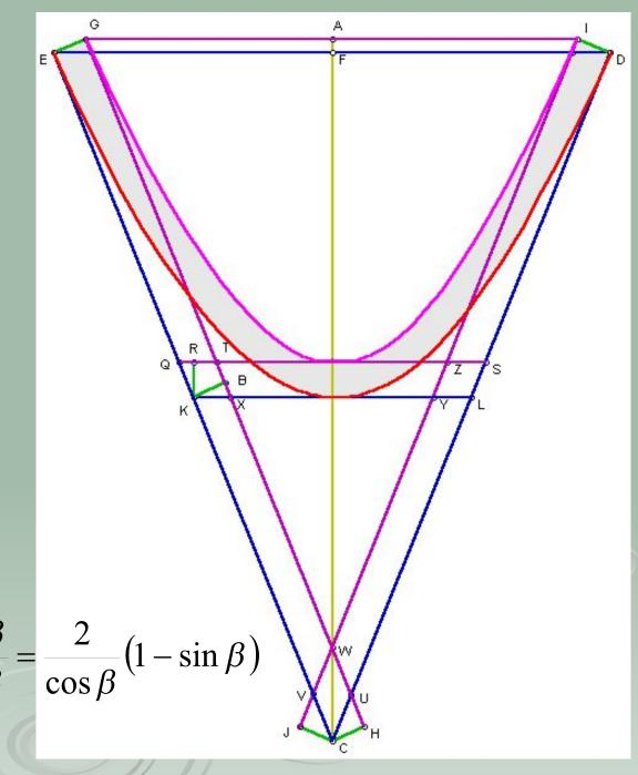
Следствие 6. Параболическая поверхность после обгорания, обледенения или покраски теряет свойства фокусировать отражённые лучи в одной точке.
