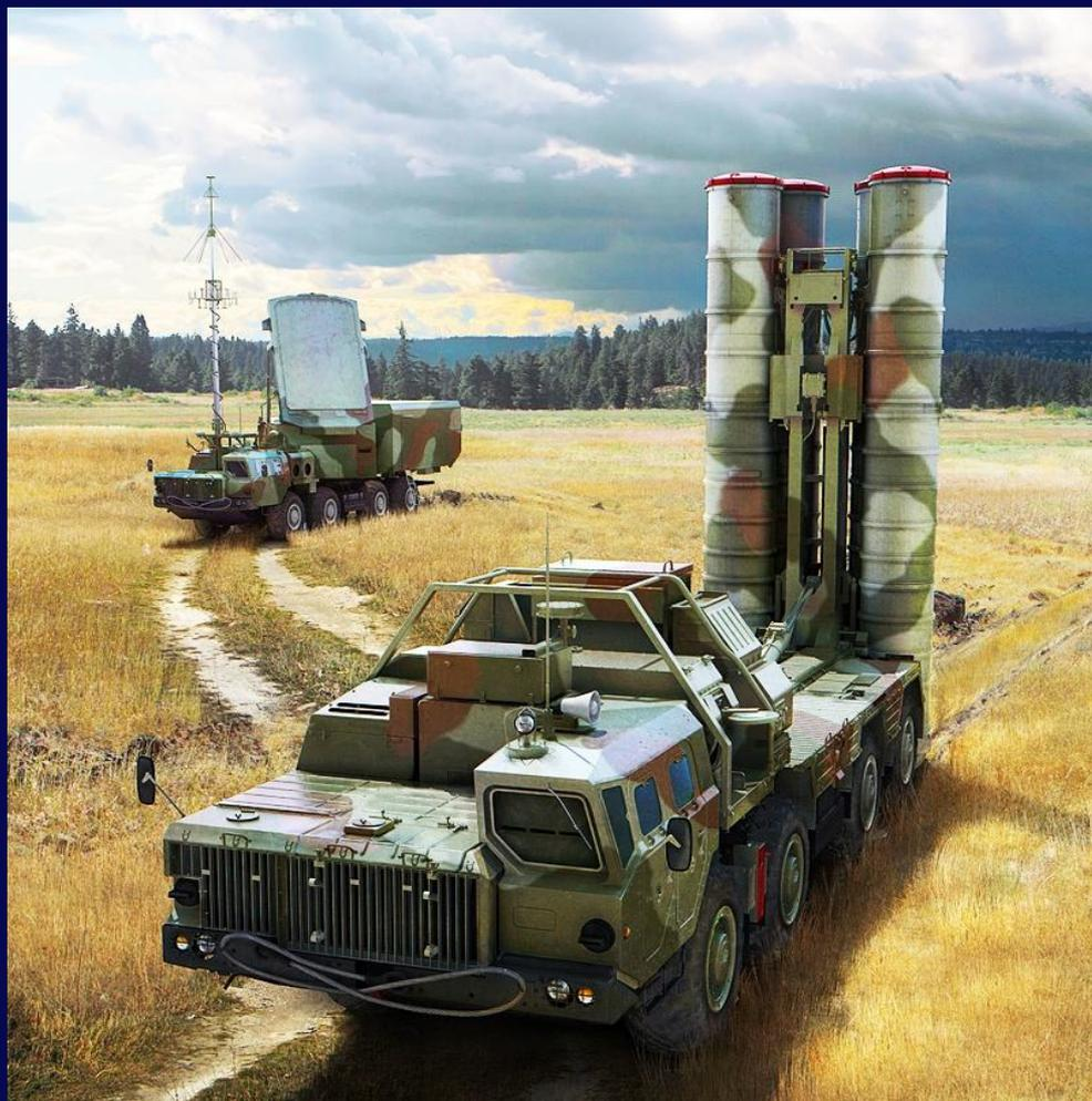
Зенитные ракетные системы семейства С-300 считаются одними из самых мощных систем противовоздушной обороны (ПВО) в мире. Разработка этой системы началась в 1960-х годах, когда вооруженные силы СССР потребовали создания мобильного многоканального комплекса средней дальности, способного защищать небо страны от массированных налетов современных машин с использованием управляемого вооружения.
