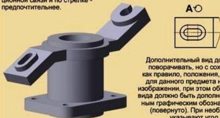
Дополнительный вид допускается поворачивать, но с сохранением, как правило, положения, принятого для данного предмета на главном изображении, при этом обозначение вида должно быть дополнено условным графическим обозначением  $\odot$  (повернуто). При необходимости указывают угол поворота.
