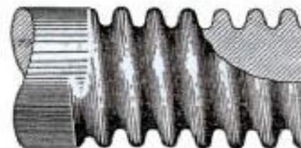
**трапецидальная резьба** имеет профиль в виде равнобочной трапеции с углом 30° между боковыми сторонами
