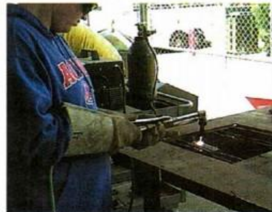
Рис. 23. Пламя ацетиленовой горелки используют для резки и сварки металлов
