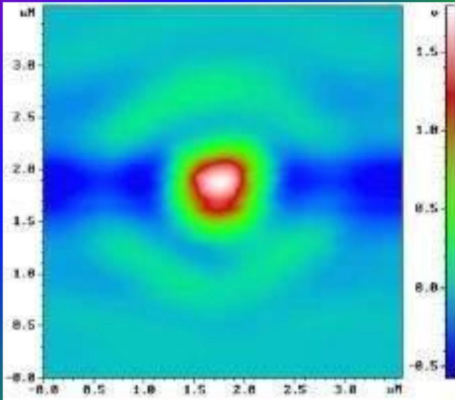
Картина дифракции, возникающая при фокусировании света объективом обычного оптического микроскопа.
