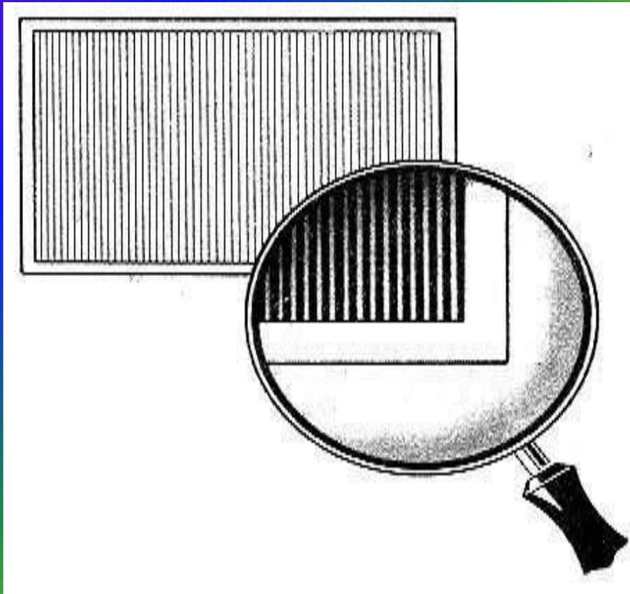
Дифракционная решетка представляет собой прозрачную пластинку с нанесенной на ней системой параллельных непрозрачных полос, расположенных на одинаковых расстояниях друг от друга.
