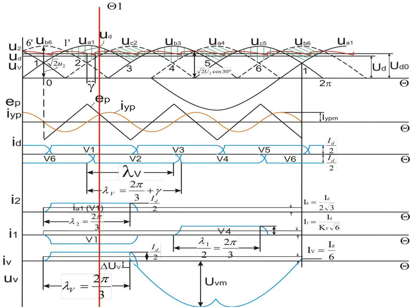
Рисунок 6.3.4 - Временные диаграммы напряжения вторичной обмотки  $u_2$ , выпрямленного напряжения  $u_d$  и тока  $i_d$ , напряжения  $e_p$  и токи  $i_{yp}$  уравнивательного реактора, токов фазы a1 вторичной  $i_2$  и фазы A первичной  $i_1$  обмоток трансформатора, тока  $i_v$  и обратного напряжения диодного плеча  $u_v$  диода шестипульсовой схемы «Звезда – две взаимно обратные звезды с уравнительным реактором» при  $\gamma > 0$
