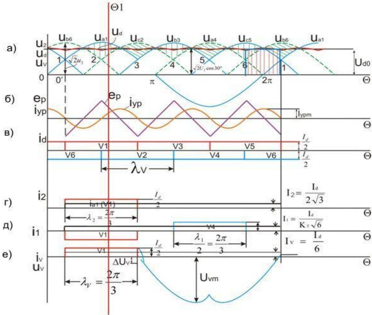
Рисунок 6.3.3 - Временные диаграммы напряжения вторичной обмотки  $u_2$ , выпрямленного напряжения  $u_d$  и тока  $i_d$ , напряжения  $e_p$  и тока  $i_{yp}$  уравнивающего реактора, токов фазы  $a_1$  вторичной  $i_2$  и фазы А первичной  $i_1$  обмоток трансформатора, тока  $i_v$  и обратного напряжения диодного плеча  $V_1$   $u_v$  диода шестипульсовой схемы «Звезда – две взаимно обратные звезды с уравнивающим реактором» при  $x_d = \infty$  и  $\gamma = 0$ .
