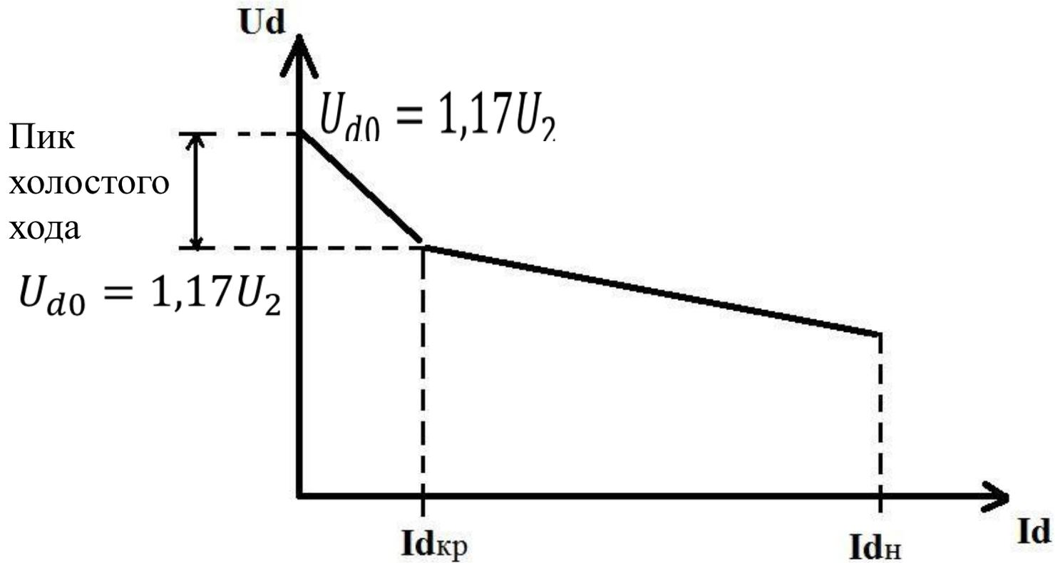
Рисунок 6.3.6 – Внешняя характеристика шести пульсовой схемы звезда – две обратных звезды с уравнительным реактором
