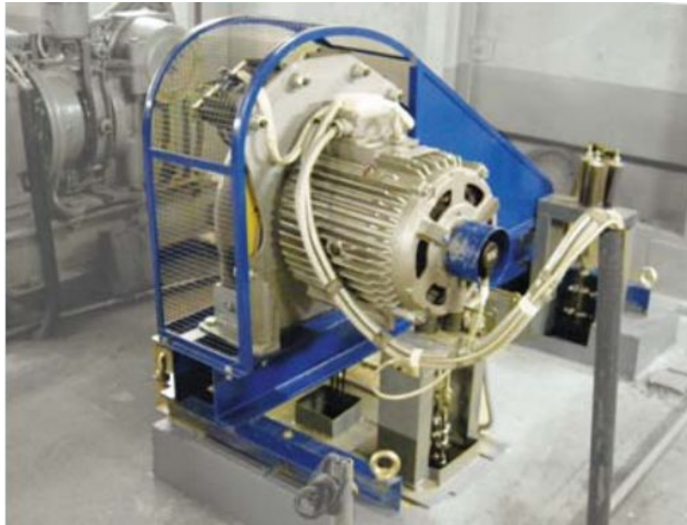
Безредукторная лебедка с тихоходным асинхронным двигателем
