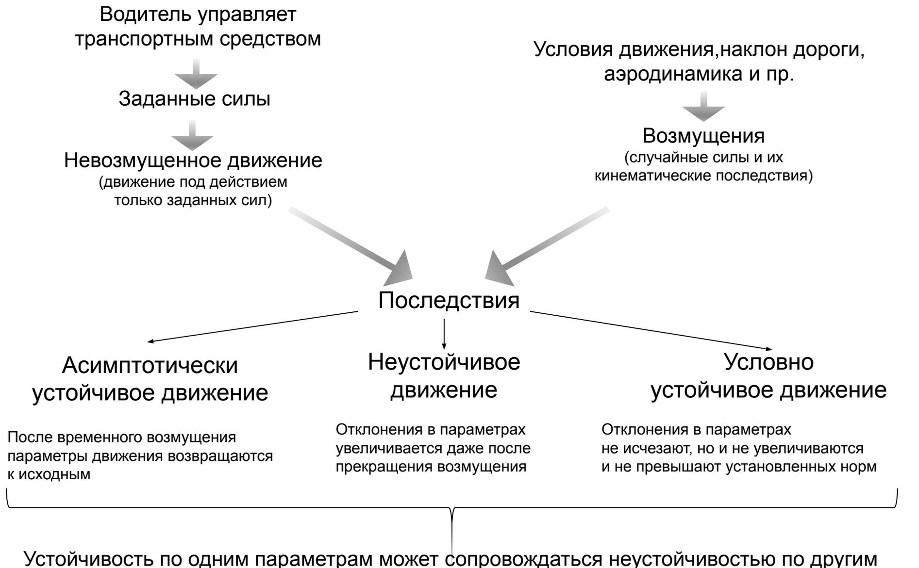
**Устойчивость** – совокупность свойств АТС, определяющих *критические параметры* по устойчивости движения и положения автомобиля и его звеньев.
