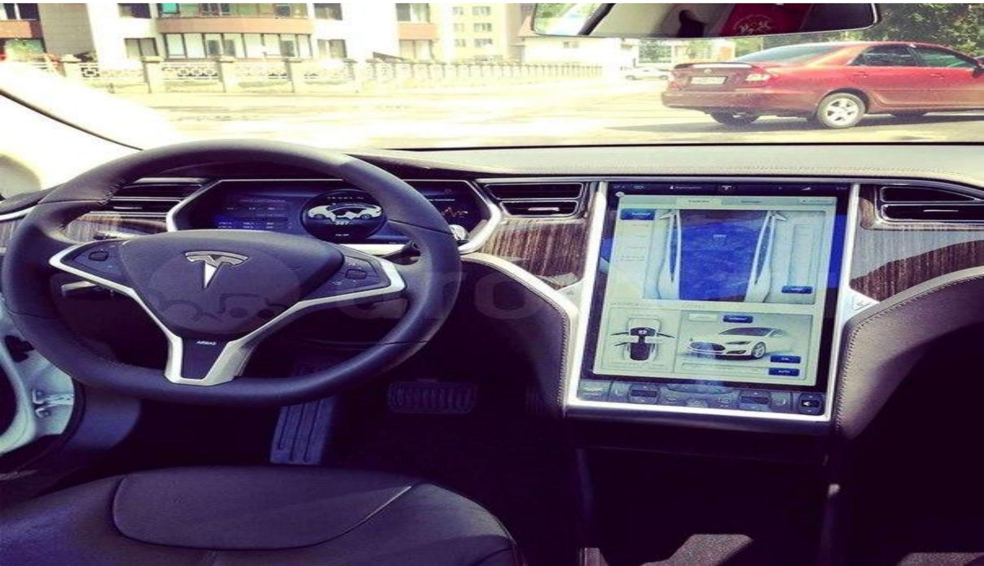
Салон автомобиля почти полностью лишён механических органов управления — кнопок и рычагов. Центральное место занимает огромный 17-дюймовый сенсорный дисплей с разрешением 1920x1080, который позволяет управлять всеми системами автомобиля.
