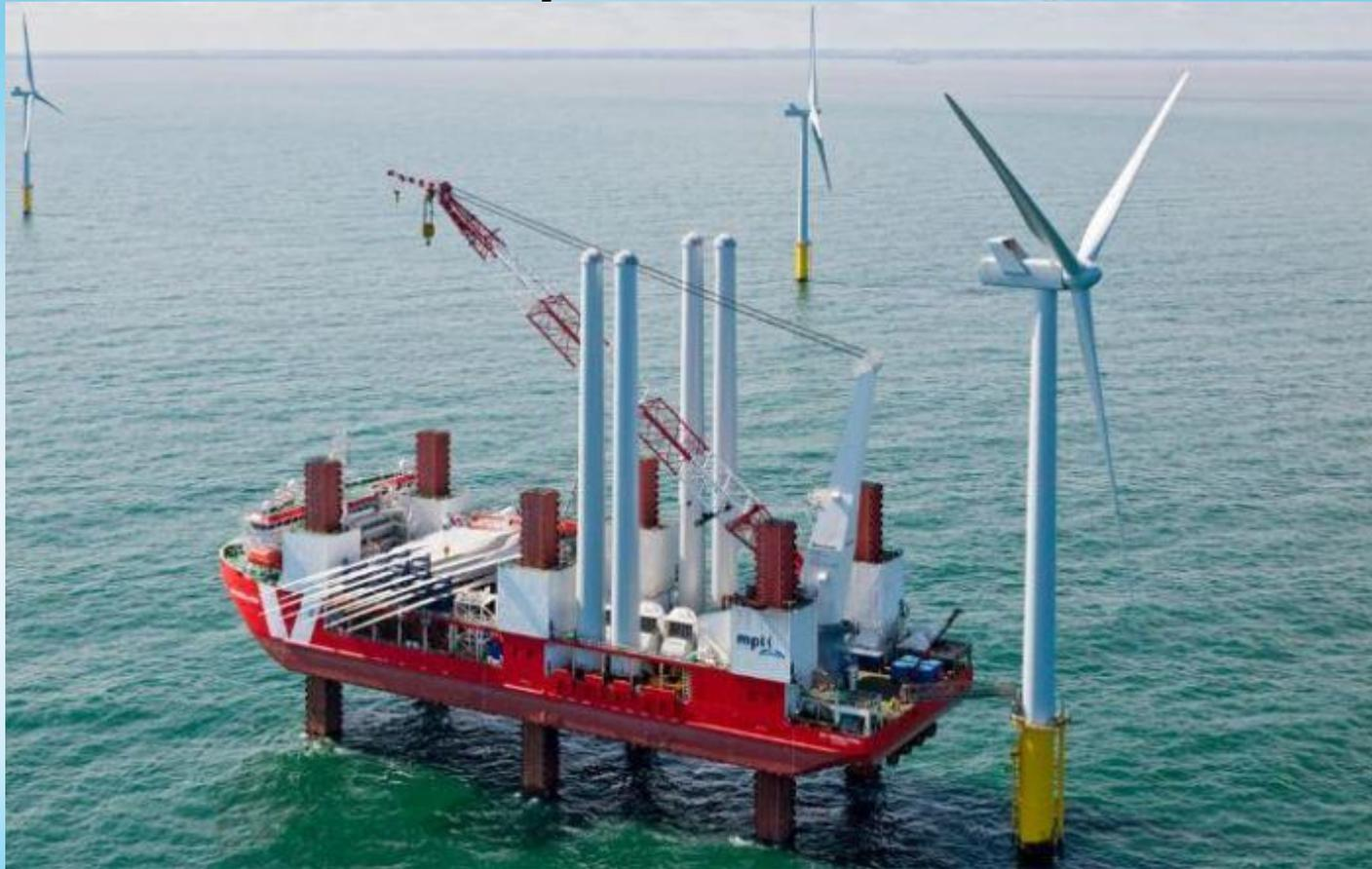
Узкоспециализированный инженерный корабль, который используется для установки воздушных турбин на воде. Корабль в момент монтажа поднимается над водой при помощи специальных ног.
