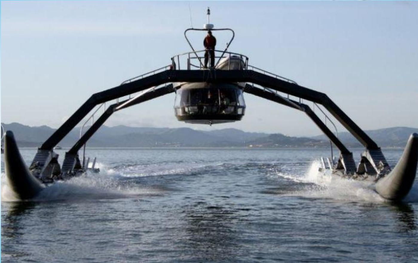
А вот творение компании Marine Advanced Research под названием Proteus WAM-V. Такие «лыжи» нужны кораблю для значительного компенсирования действия волн. У корабля движущаяся кабина.
