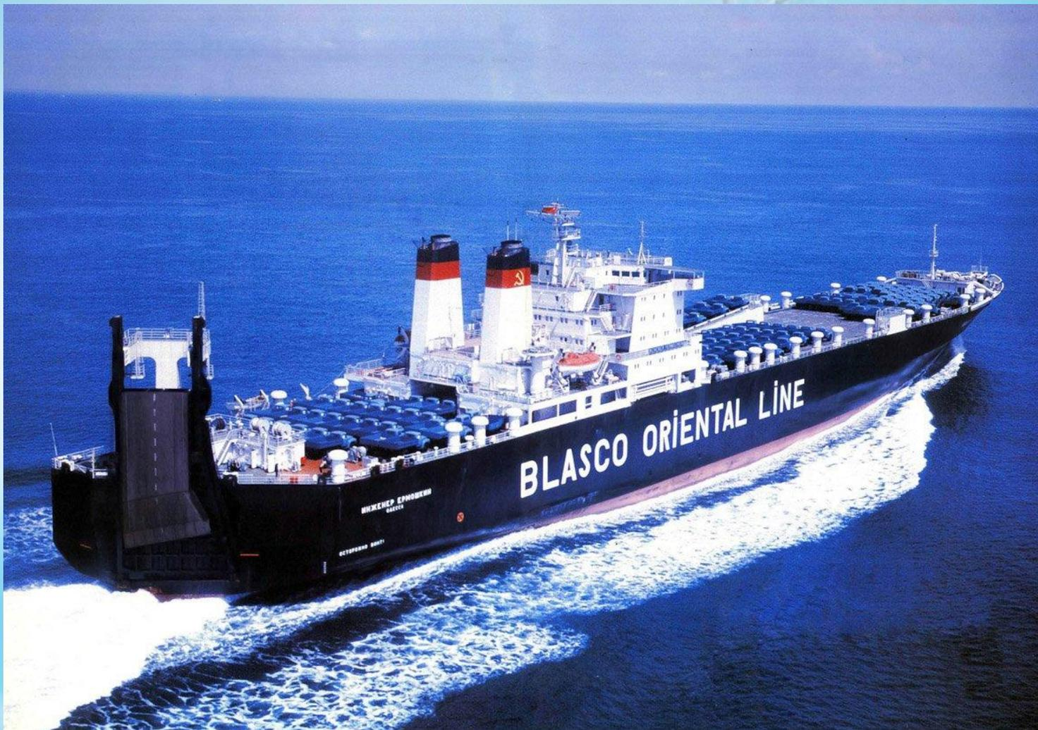
Ролкер — судно для перевозки грузов на колесной базе: автомобили, грузовой транспорт, железнодорожные вагоны
