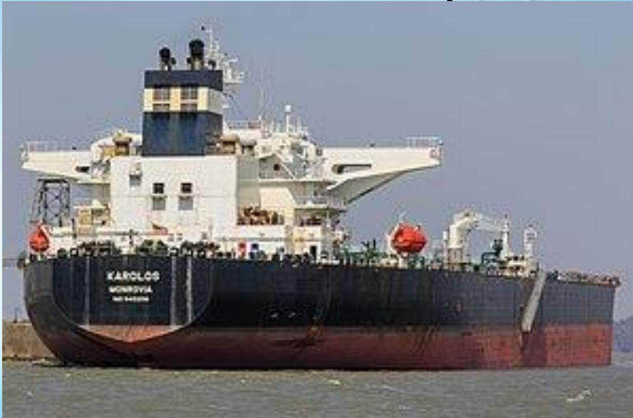
**Танкер** — морское или речное грузовое [судно](#), предназначенное для перевозки наливных [грузов](#).
