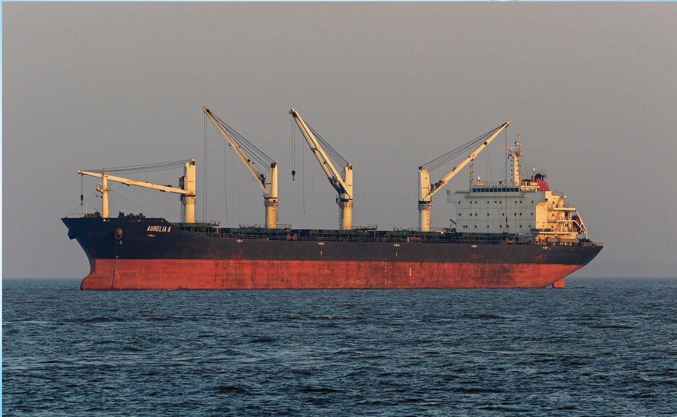
Балкер, или навалочник — специализированное судно для перевозки грузов насыпью и навалом, таких как зерно, уголь, руда, цемент и других сыпучих грузов
