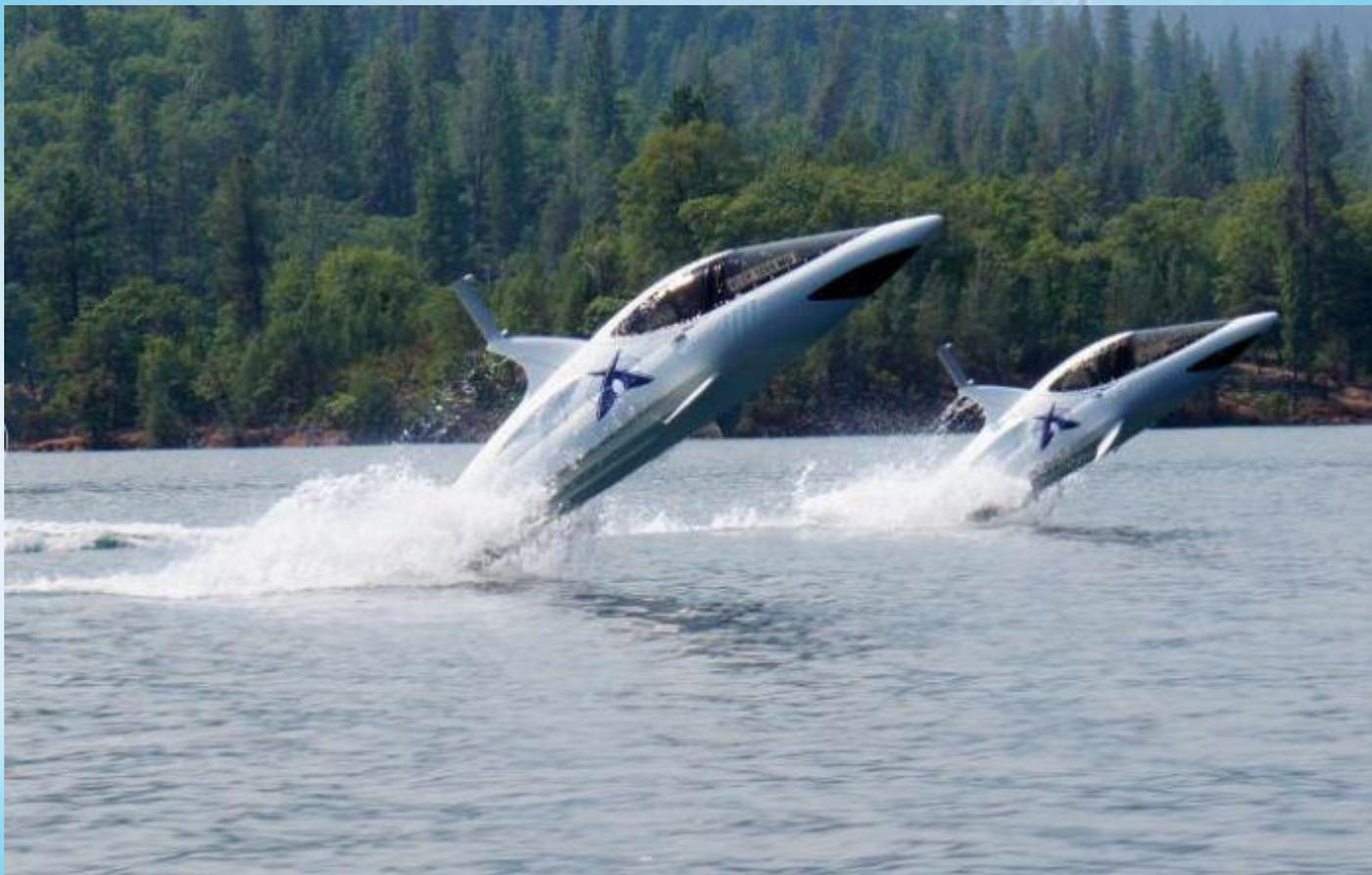
Гидроцикл-подлодка с полностью герметической кабиной разгоняется до внушительных 80 км/ч на поверхности воды. Под водой судно разгоняется до 40 км/ч.
